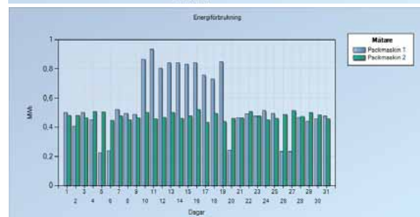
Förbrukningen kan visas per dygn för varje maskin. Exemplet visar tydligt att packmaskin 1 förbrukade mer under en period.
